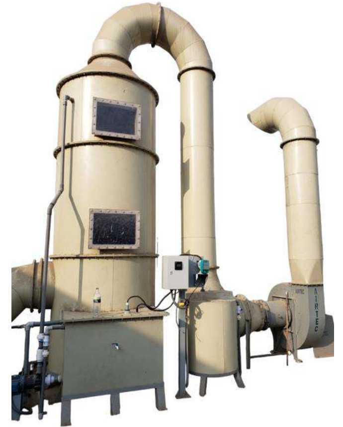
Lavador de gases (SCRUBBERS)
